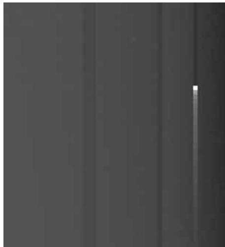
Рис. 3. Часть темного кадра ПЗС с отчётливыми следами действия ловушек. Особенно ярко выделяется эмиссионный след ловушки, на которую попал сигнал от «горячего» элемента
